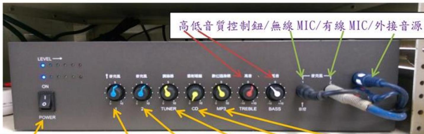
電源開關 音量調整: 無線 MIC、有線 MIC、教學 PC、HDMI、外接音源
